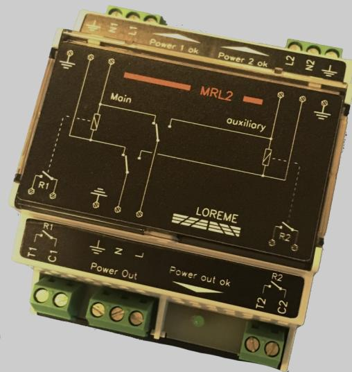
Le MRL2 permet de fournir une protection efficace contre les défaillances d'alimentations AC. Grâce au découpage de deux alimentations, la défaillance de l'une d'elle reste sans impact sur la sortie, l'autre prenant automatiquement sa fonction sans interruption de service.
